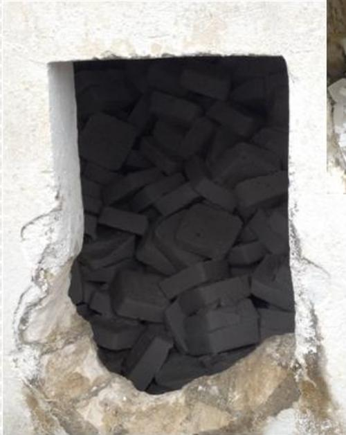
Almacenamiento sulfato de alúmina sólido y dilución a saturación.
